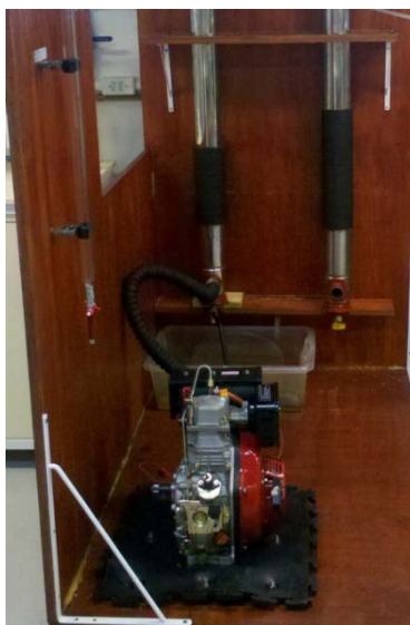
Figura 1: Motor estacionário acoplado à coluna de absorção.
